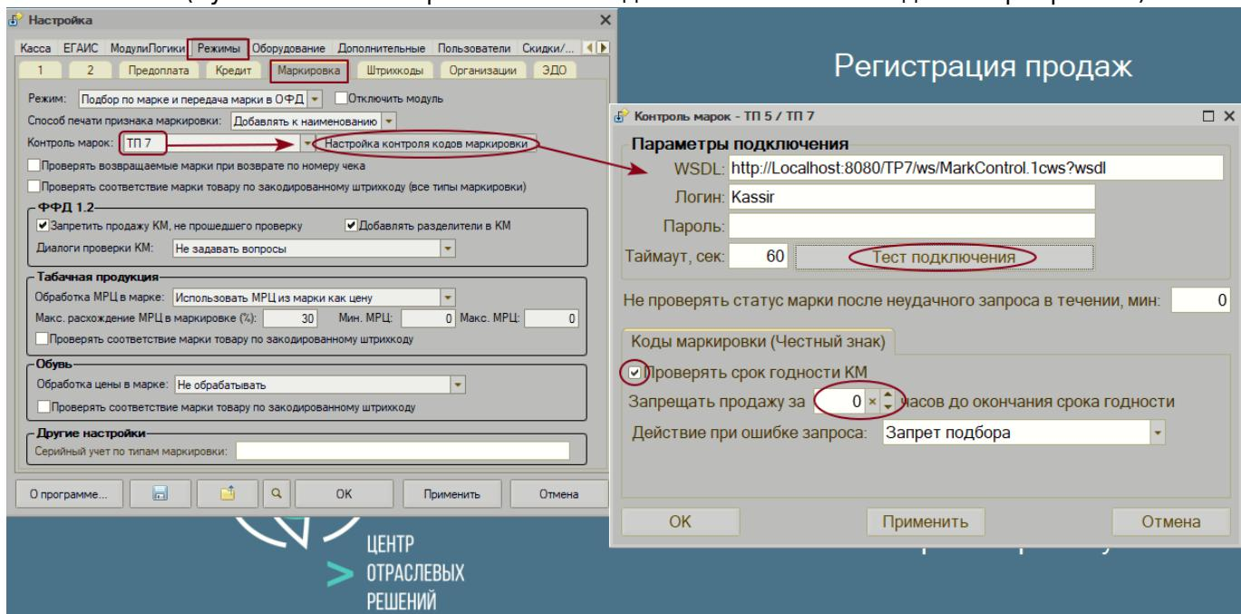
Нажатие кнопки «**Настройки контроля кодов маркировки**» открывает форму «**Контроль марок — ТП 5 / ТП 7**», которая позволяет включить сервис для контроля КМ. Кнопка доступна, если в поле «**Контроль марок**» будет указана конфигурация «**Торговое предприятие 7**». Затем следует **определить адрес WEB-сервиса «MarkControl»** и задать пользователя под которым будет работать сервис.
